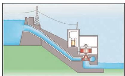
Мал. 3. Схема використання гідроенергії на ГЕС.
